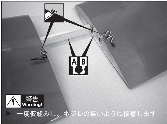
**10** 主翼中央部に主翼取り付け補強板を接着します。
